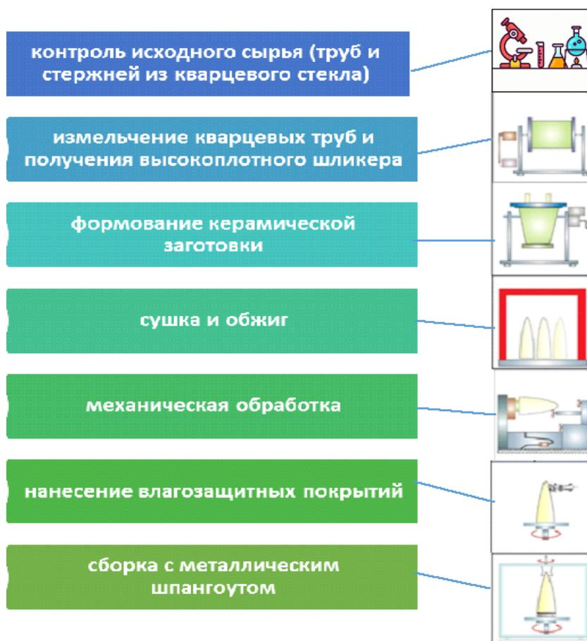
Рисунок 1.2. Схема изготовления обтекателей из кварцевой керамики.
