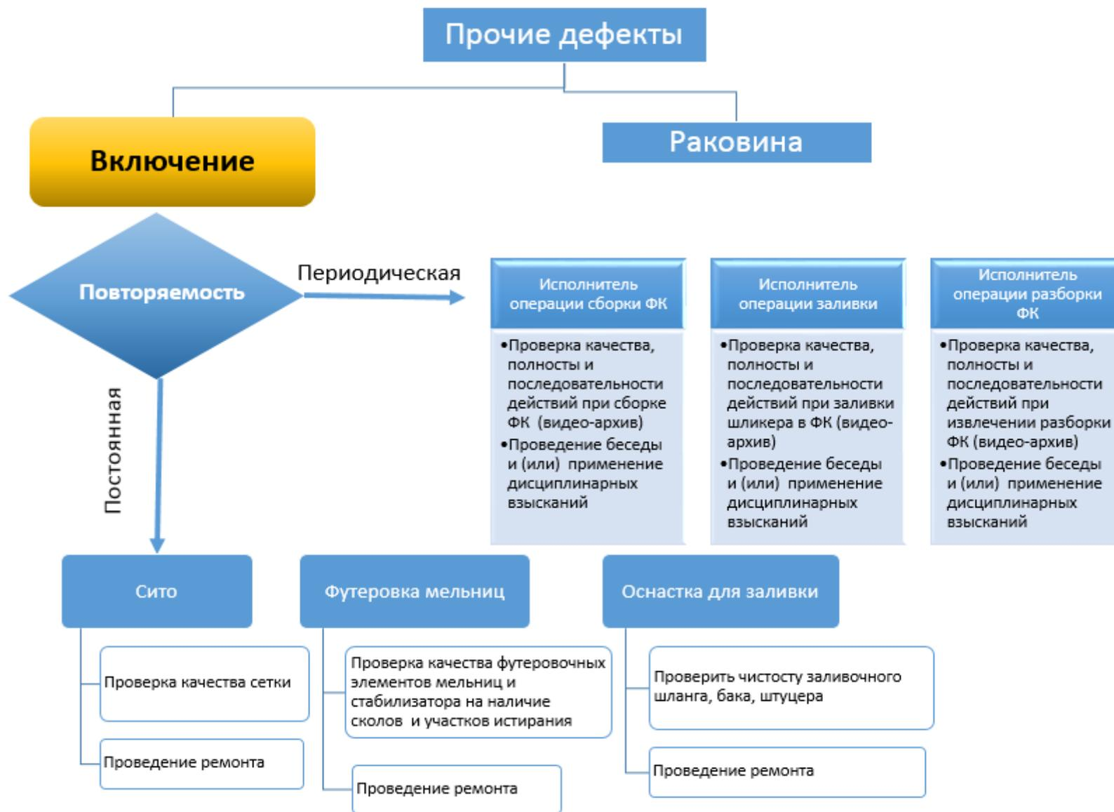
Рисунок 6.6 – Схема алгоритма поиска причины образования включения.
