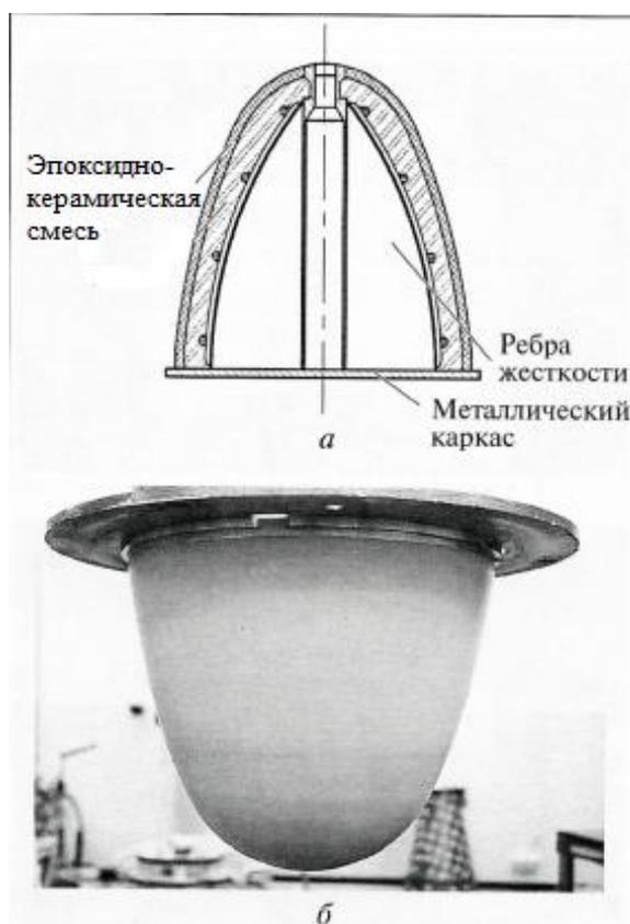
Рисунок 5.1 – Сердечник (или модель) для формования керамических изделий [46]: а) схематическое представление; б – внешний вид.
