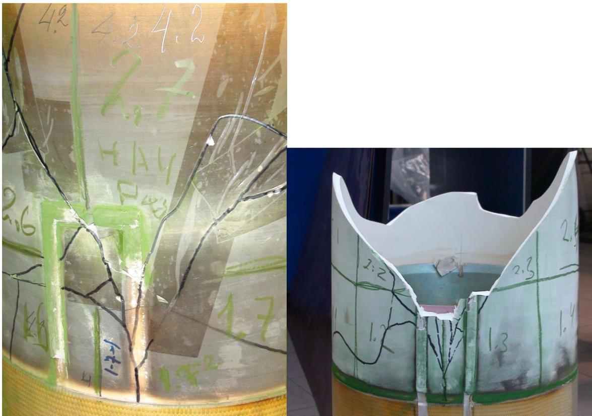
Рисунок 3.1. Разрушенный керамический обтекатель.
