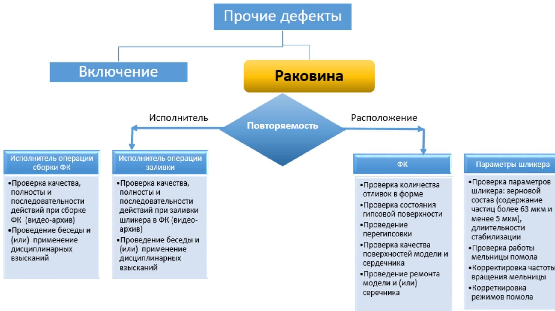
Рисунок 6.7 – Схема алгоритма поиска причины образования раковины.
